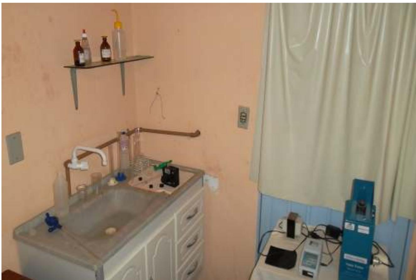
**IMAGEM 13:** No laboratório físico-químico são analisados os padrões de turbidez, cor, ph, flúor e cloro. As análises bacteriológicas são realizadas no laboratório da ETA de Arroio dos Ratos.
